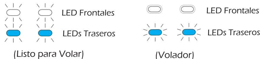
① Cargue la batería completamente del dron y empareje el dron con el transmisor, los indicadores traseros se prenderán de color azul y los indicadores de enfrente se prenderán de color blanco. Cuando las cuatro luces estén prendidas esto indicara que el dron esta listo para volar. Cuando el dron este en vuelo, las luces de enfrente se quedaran prendidas y las luces de atrás parpadearan constantemente.
